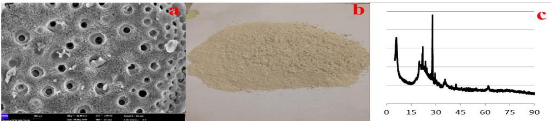
Şekil 2. Diatomit (a) FESEM görüntüsü, (b) fiziksel görünüm, (c) XRD grafiği
